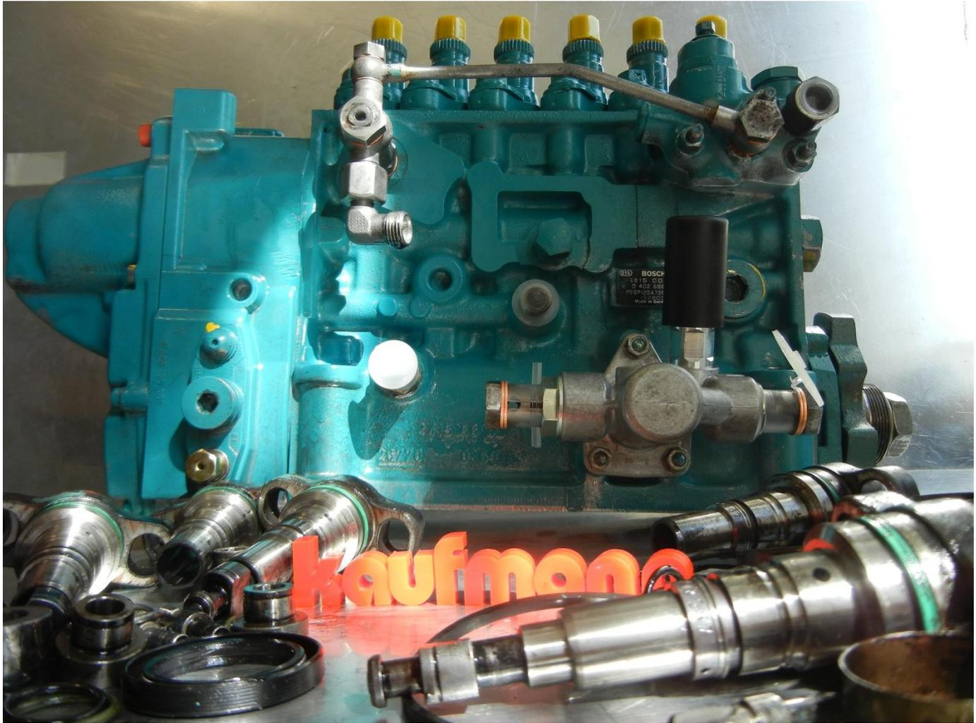
Quelle: Kaufmann, 0 402 696 801, komplette Pumpenrevision mit Druckventilen, Pumpenelementen, allen Lagern und Dichtungen unter Fr. 3000.—
